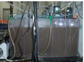
写真2 排水処理実験装置(処理槽)
