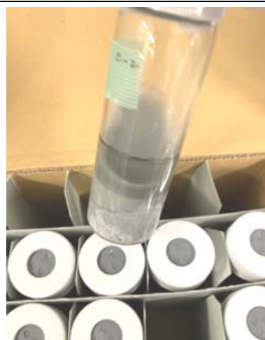
写真 12：培養中は可能な限り 1 日ごとに手で 10 秒強撹拌する（試料の底部が懸濁するまで）。土日祝等を挟む場合は、本作業はスキップ
