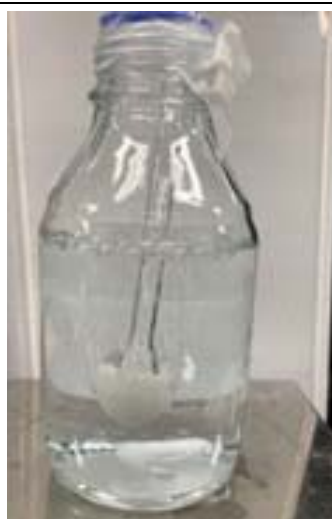
写真2：MilliQ をスターラーで攪拌しつつ，円筒ガス噴射管を用いて N 2 ガスで脱気
