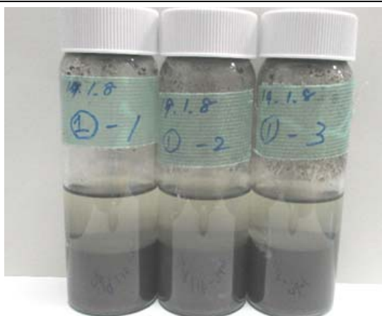
写真 11：最低 3 反復で試料を作成し（同一試料を 3 検体用意する），40℃の恒温槽で培養する
