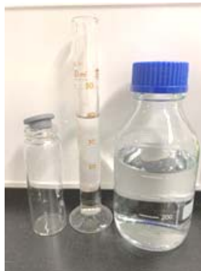
写真4：脱気水を40 mL 計量し，バイアル瓶へ静かに注ぐ
