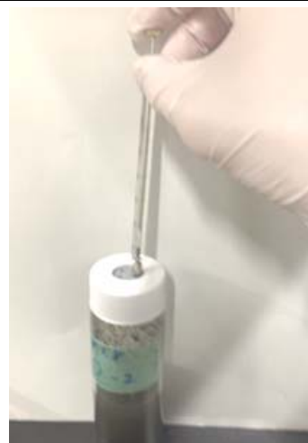
写真 14：シリンジを用いてバイアル瓶内から気相をら 100 \mu\text{L} 採気し，気相中の硫化水素ガス濃度を測定する。測定における希釈は 10 倍希釈の場合は，10 \mu\text{L} をバイアルから，90 \mu\text{L} を外気から採気する。50 倍希釈の場合は，2 \mu\text{L} （最小の目盛）をバイアルから，98 \mu\text{L} を外気から採気する。これ以上の希釈はガスバックを使う
