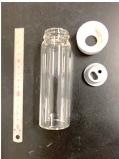
写真3：日電理化学硝子 ガスクロバイアル SVG-100（無色）標準セット（瓶：外径φ40×全長L=120 肉厚t=1.8）
