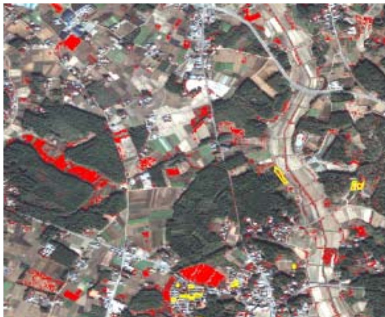
図6-36 狭域・土地被覆分類変化の画像解析結果 （東西約2km・南北約 2km 検知対象は黄色のポリゴン線、検知結果は赤色のラスタで示す）
