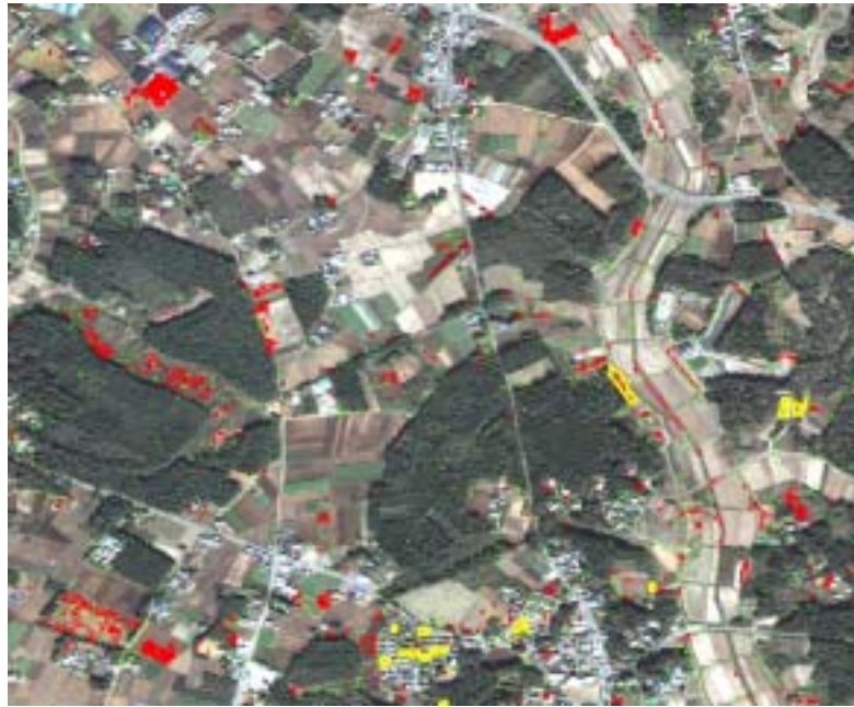
図6-42 狭域・NDVI変化の強いセグメンテーション表示 (東西約2km・南北約 2km 検知対象は黄色のポリゴン線、検知結果は赤色のラスタで示す)
