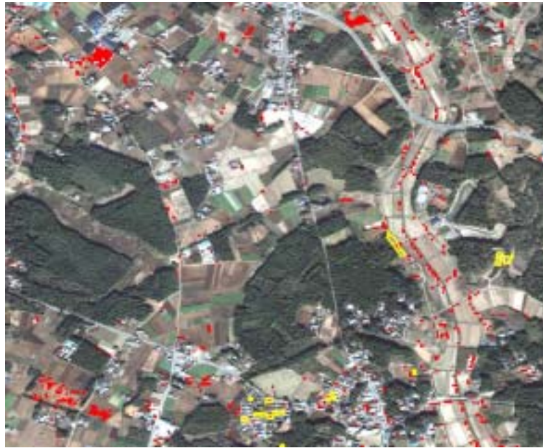
図6-43 広域高分解能・NDVI変化のセグメンテーション表示 (東西約2km・南北約 2km 検知対象は黄色のポリゴン線、検知結果は赤色のラスタで示す)
