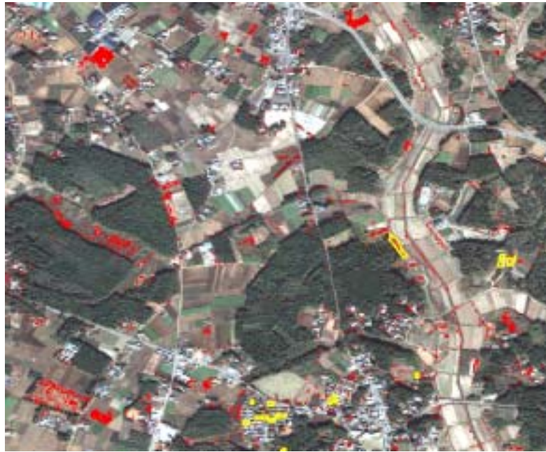
図6-41 狭域・NDVI変化の弱いセグメンテーション表示 (東西約2km・南北約 2km 検知対象は黄色のポリゴン線、検知結果は赤色のラスタで示す)
