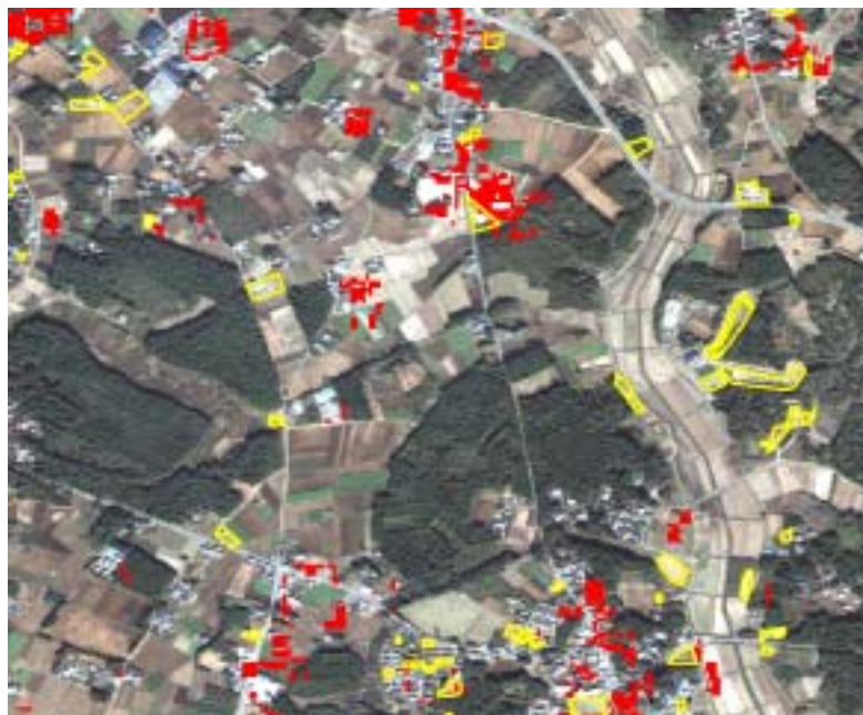
図6-39 広域高分解能・空間情報解析の画像解析結果 (東西約2km・南北約 2km 検知対象は黄色のポリゴン線、検知結果は赤色のラスタで示す)
