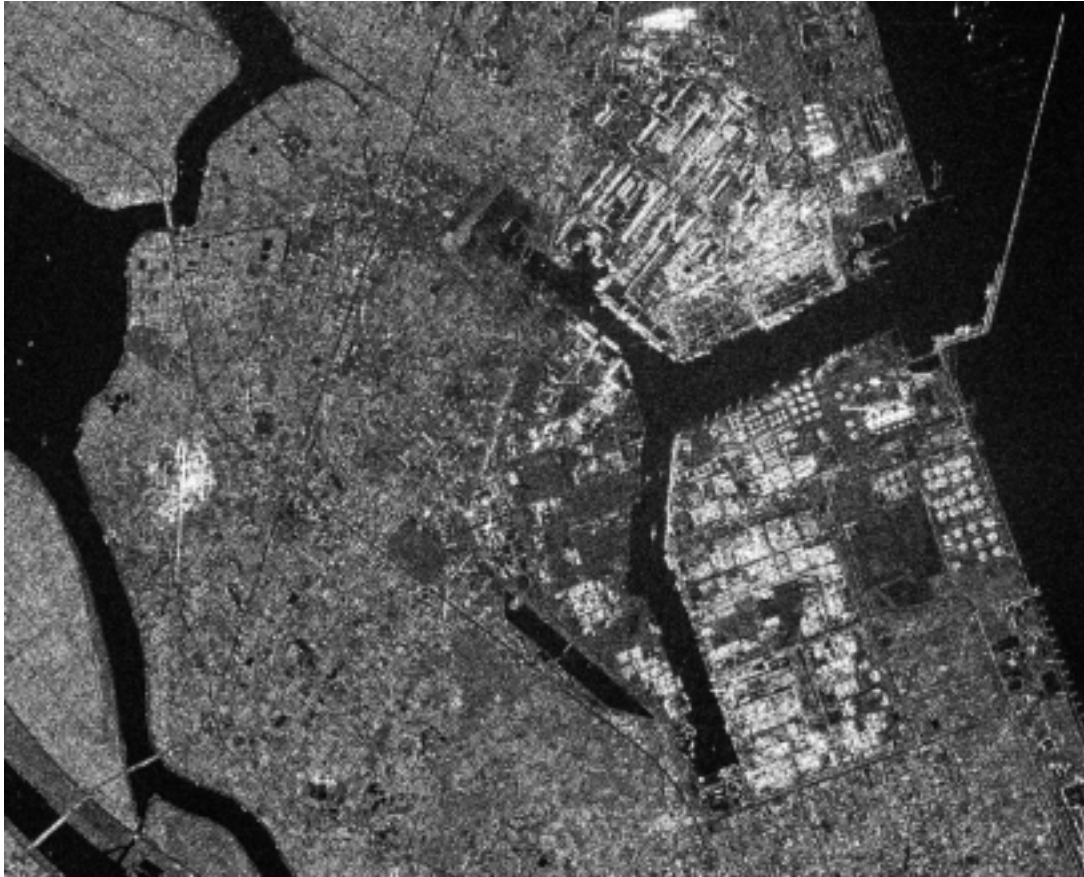
図5-7：合成開口レーダ画像の例（RADARSAT-1 STANDARD）
