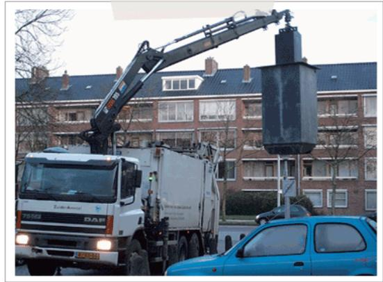
オランダのごみ収集：ごみのたまった地下コンテナをクレーンで吊り上げてごみを回収する方式です。
