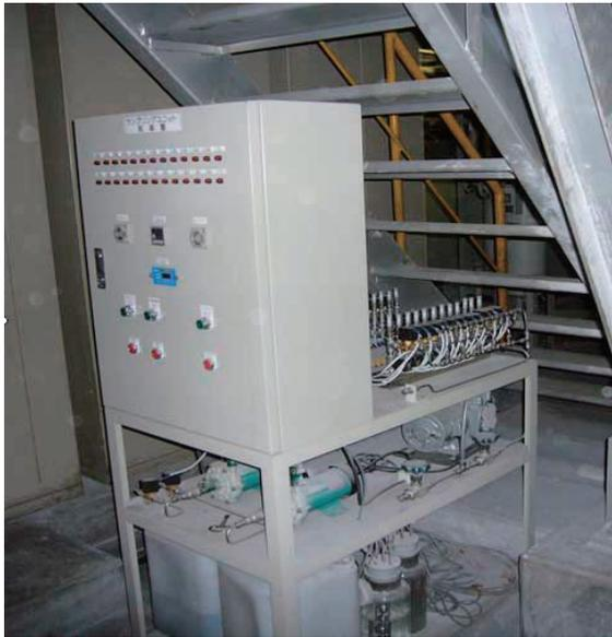
焼却施設に設置された有機ハロゲン類の測定装置
