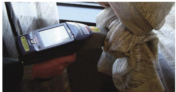
ハンディータイプの蛍光X線分析計でカーテン素材中の元素を調べています
